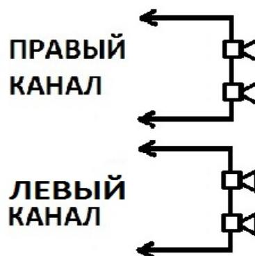
При кабельном подключении Гр к усилителю сопротивление шлейфа (кабель + один или два Гр), присоединяемому к каждому из выходных каналов усилителя, не должно превышать 16 Ом. Сопротивление каждого Гр 6 Ом. Для снижения общего сопротивления шлейфа рекомендуется использовать кабель возможно большего сечения, или соединение нескольких кабелей параллельно для снижения сопротивления шлейфа.
