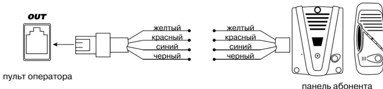
**Внимание!!! Абонентские устройства (пульт оператора и внешняя панель) переговорных устройств DD – 205/DD – 215 не совместимы с абонентскими переговорными устройствами DD-301.**
